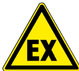
Kenzeichnung des explosionsfähigen Bereiches gemäß VEXAT
